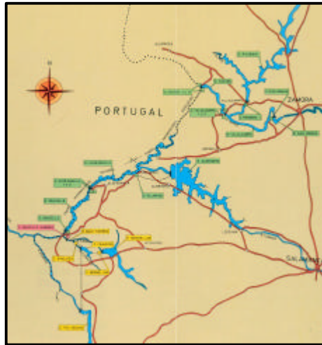
Figura 8. Esquema actual del Sistema Duero, con indicación de las centrales reversibles.
