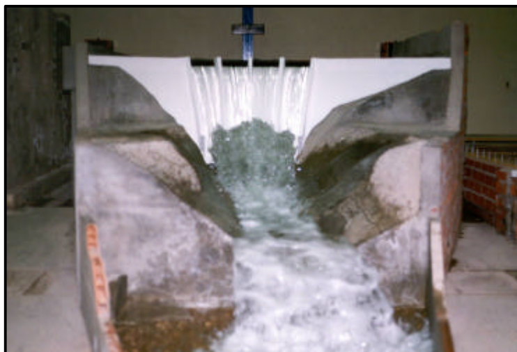
Figura 5. Ensayos en modelo hidráulico en el Laboratorio de Muelas del Pan.
